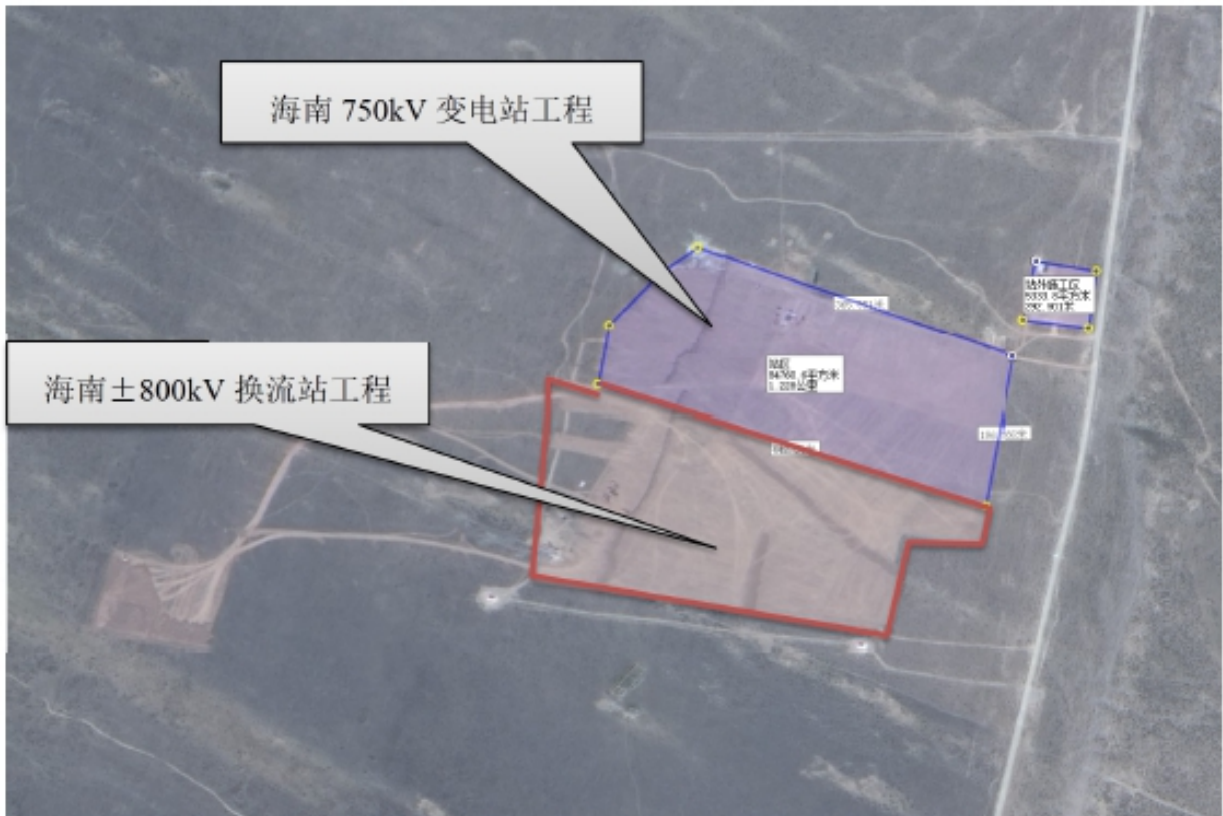
2018年第四季度海南750千伏变电站施工扰动面积（影像资料时间：2018年10月17日）
