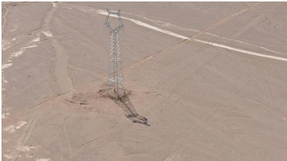
无人机航拍解译塔基施工场地扰动面积
