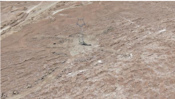
无人机航拍解译塔基施工场地扰动面积
