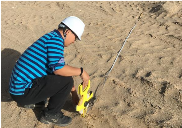
采用皮尺实地测量施工扰动范围
