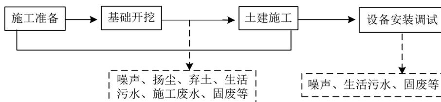
图 3.3-1 变电站施工工艺及产污环节
