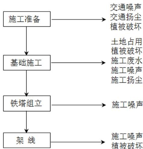
图 3.3-2 输电线路施工工艺及产污环节
