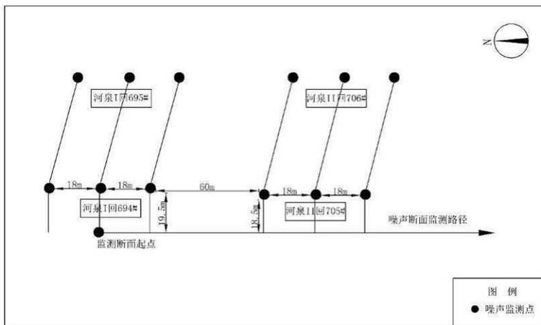
图 6.2-5 750kV 线路噪声监测点示意图
