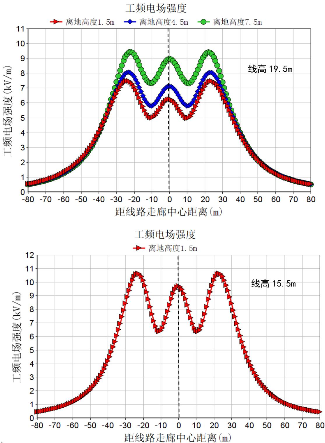
图 6.1-5 工频电场强度分布图—ZBC27153 直线塔
