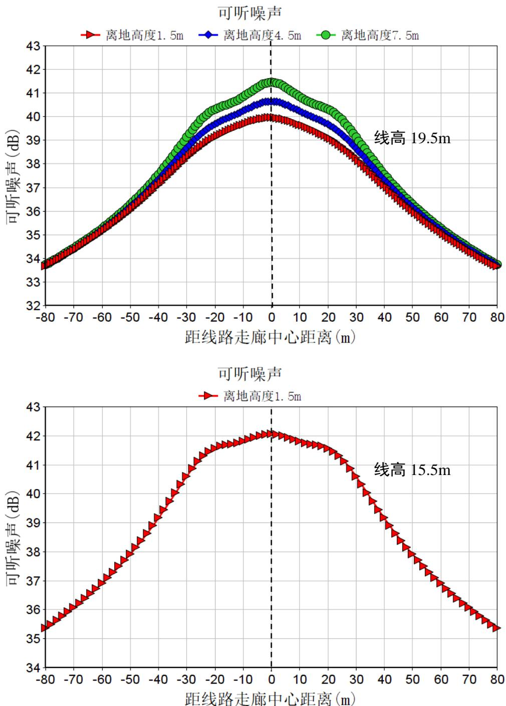
图 6.2-6 本项目单回路 ZBC27153 型直线塔噪声理论预测分布图
