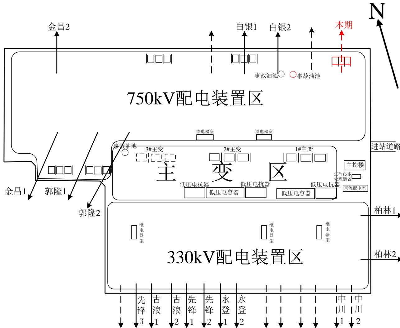
图 3.1-5 武胜 750kV 变电站总平面布置示意图
