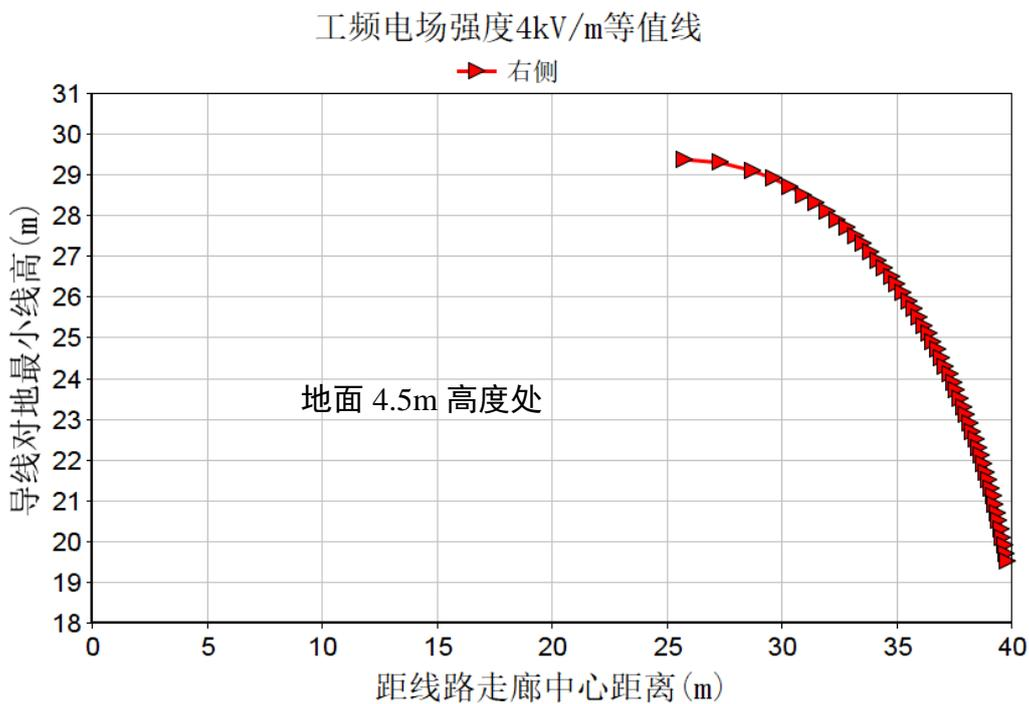
图 6.1-11 单回路工频电场强度 4kV/m 预测结果分布图
