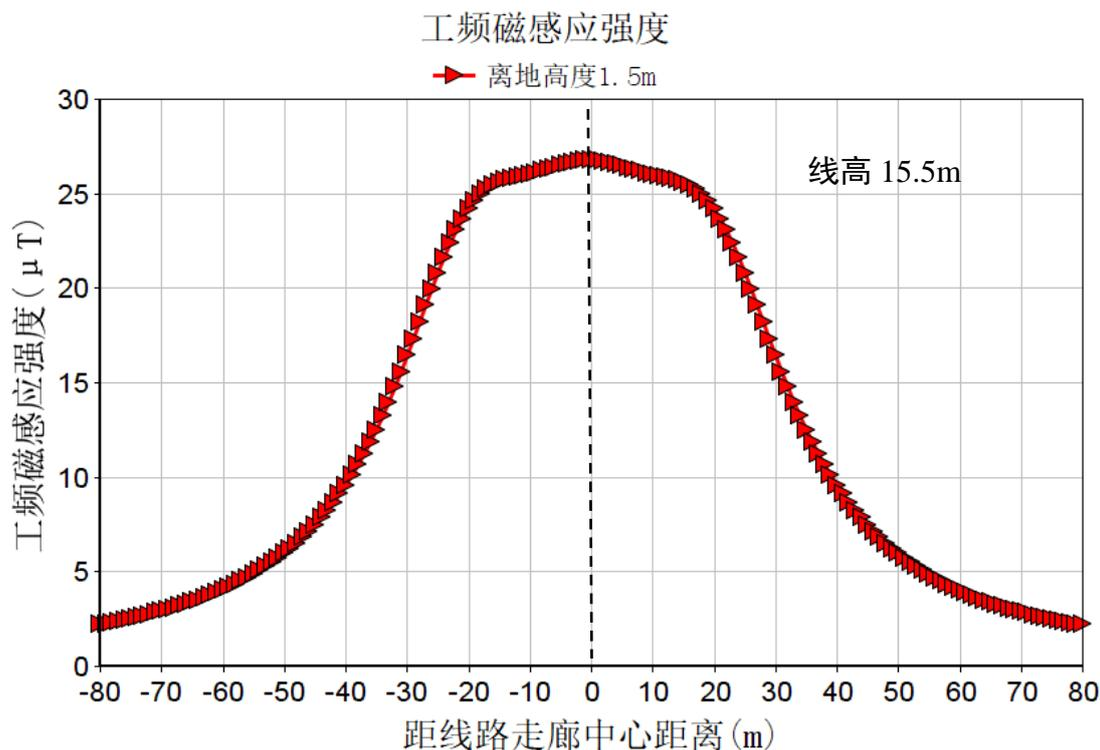
图 6.1-7 工频磁感应强度分布图—ZBC27153 直线塔
