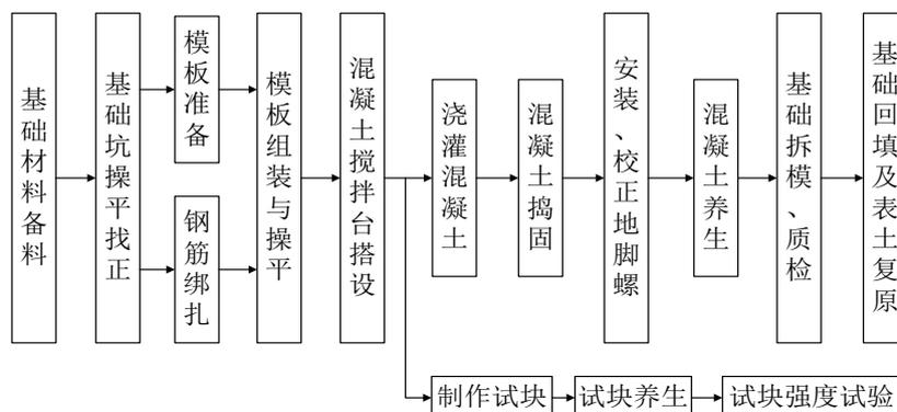
图 3.3-4 基础施工工艺流程图
