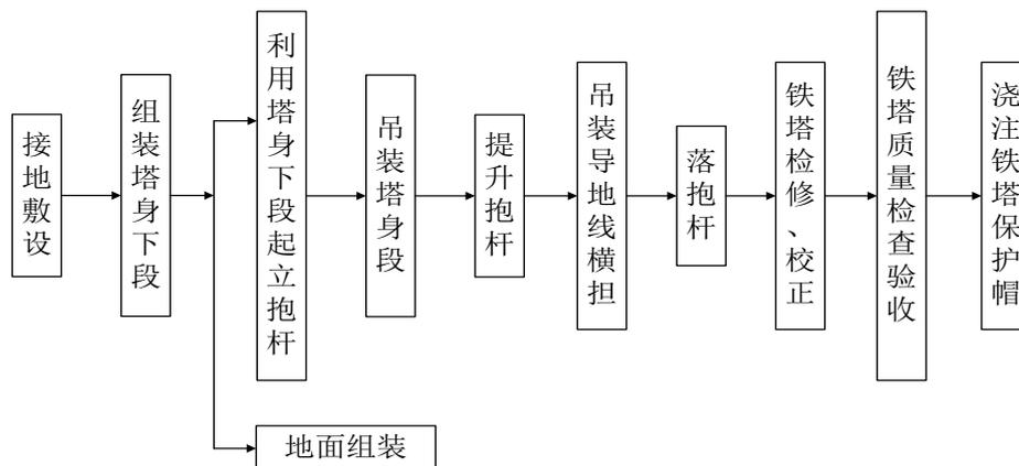
图 3.3-5 铁塔组立接地施工工艺流程图
