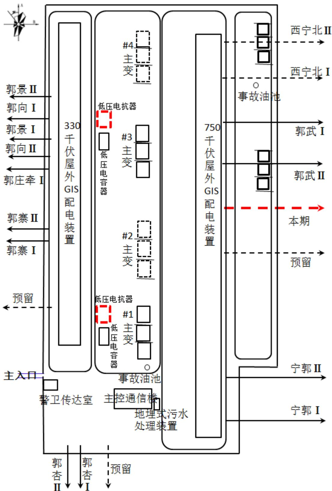
图 3.1-2 郭隆 750kV 变电站总平面布置示意图
