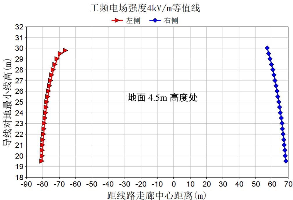
图 6.1-12 与同塔双回并行工频电场强度 4kV/m 预测结果分布图
