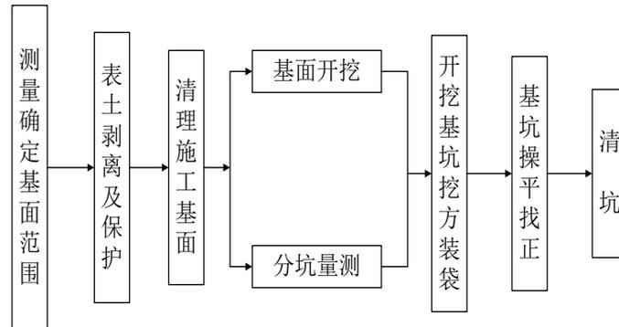
图 3.3-3 基坑开挖施工工艺流程图
